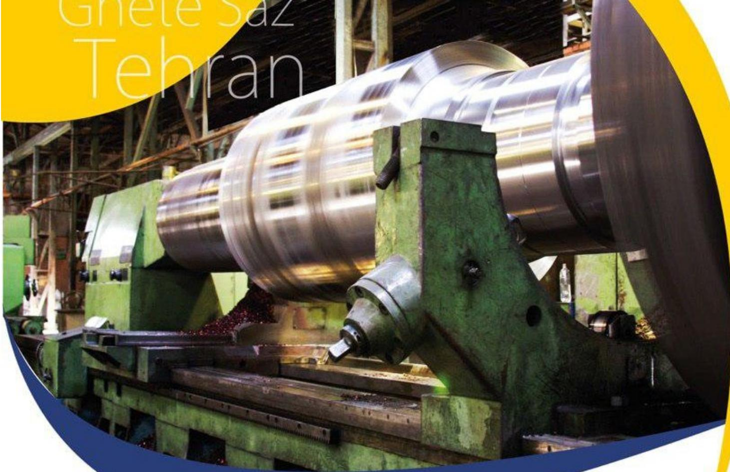
ساخت و ماشینکاری انواع غلطک و رینگ نورد گرم شامل:
